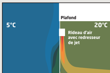
Extérieur 5°C Intérieur 20°C Ouverture de la porte Avec rideau d'air chaud
