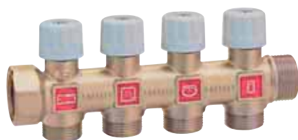
Collecteurs avec vannes d'arrêt, MF 3/4 - Entraxe : 35 mm. Étiquettes départ pour eau mitigée et eau froide.
