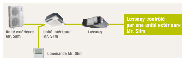
Principe de raccordement
