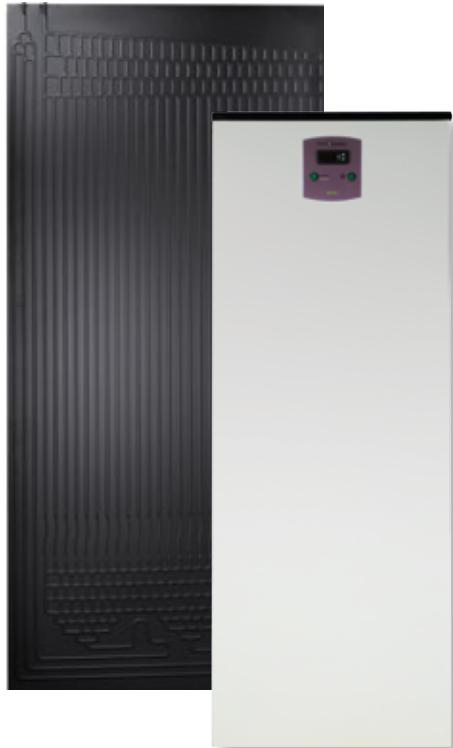
Le Neo-Energy série E est un chauffe-eau innovateur, basé sur le système de pompe à chaleur qui utilise un panneau solaire comme système d'évaporation, le système est capable d'absorber l'énergie solaire et ambiante toute l'année, même pendant les périodes froides. L'énergie captée se transmet à l'eau via un condenseur entourant l'extérieur de la cuve.
