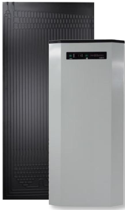
Le Neo-Energy est un chauffe-eau innovateur, basé sur le système de pompe à chaleur qui utilise une double évaporation : un panneau solaire + un échangeur intérieur. De plus, le système est capable d'absorber l'énergie solaire et ambiante toute l'année, même pendant les périodes les plus froides. L'énergie captée se transmet à l'eau via un condenseur entourant l'extérieur de la cuve.
