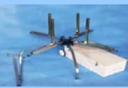
Dévideur de tubes repliables pour le déroulement des tubes de chauffage de surface lors de la pose, compact car repliable pour le transport, différentes dimensions de bobines réglables
