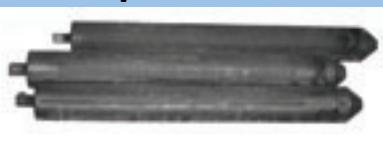
Poids permettant de contrecarrer la flottabilité de la sonde dans le forage
