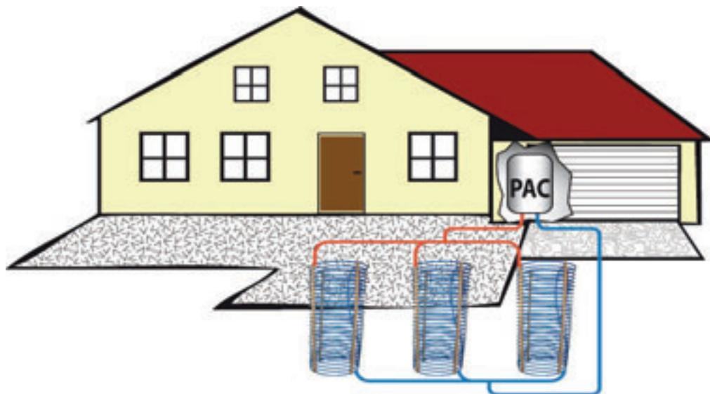
Les corbeilles géothermiques Hêkia sont des échangeurs thermiques compacts réalisés avec des résines de très haute qualité.
