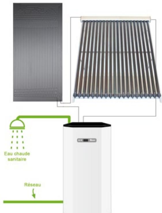
Le panneau solaire thermodynamique de double absorption garantit le fonctionnement des équipements thermodynamiques dans une multitude de conditions climatiques, étant spécialement indiqués pour les zones où les températures sont faibles malgré des niveaux de radiation solaire suffisants.
