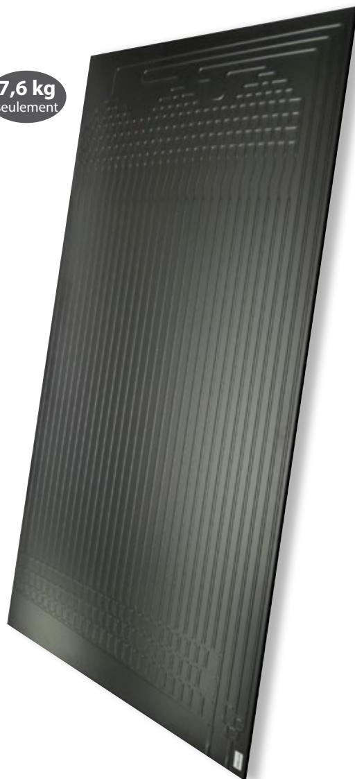
Le panneau solaire thermodynamique joue le rôle d'évaporateur dans le cycle de compression de la pompe à chaleur. A l'intérieur circule un liquide réfrigérant qui se trouve à basse température (qui peut être inférieure à 0°C), lequel capte la radiation solaire ainsi que l'énergie ambiante. Le condenseur se trouve en contact avec l'eau à chauffer. Le groupe thermodynamique contient le reste des éléments du système comme le compresseur, la valve d'expansion, etc...
